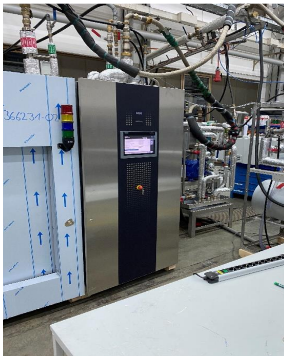
Billede af laboratorie autoklave ved en FAT-test
